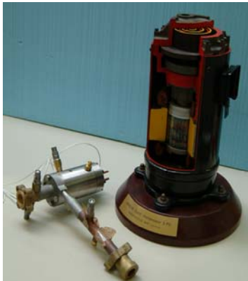
Abb. 1 Grössenvergleich: Der von Jürg Schiffmann entwickelte Turbokompressor (l.) neben einem herkömmlichen Kompressor.
